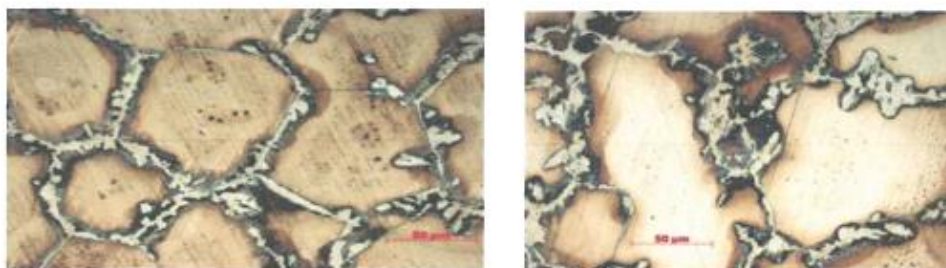
Рисунок 1. Микроструктура стали 110Г13Л до термической обработки (литой): а-х50; б-х100 (получены авторами)
