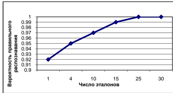
**Рисунок 10** – График зависимости вероятности правильного распознавания сложного объекта с помощью R-алгоритма от числа эталонов
