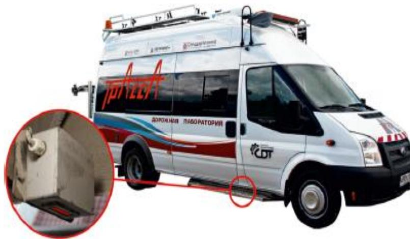
**Рис. 4. Лазерный профилометр на ПДЛ «Трасса»**
