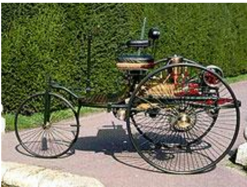
2-расм. К.Бенз томонидан яратилган жаҳондаги биринчи 3-4 от кучига эга бўлган бирцилиндрли ички ёнув двигатели ўрнатилган уч ғилдиракли автомобил (1885 йил)
