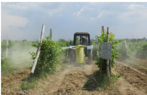
Рис. 1 Опылинитель ОШУ-200М в агрегате с трактором Беларусь 82.1 в работе(вид сзади).
